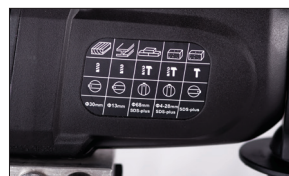
Tablica max. prečnika bušenja za različite materijale
